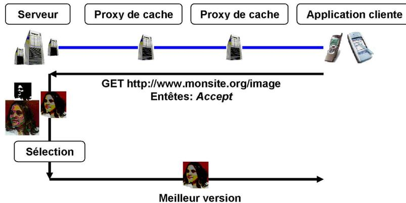
FIG. 2.6 – Modèle de négociation du protocole HTTP/1.0
