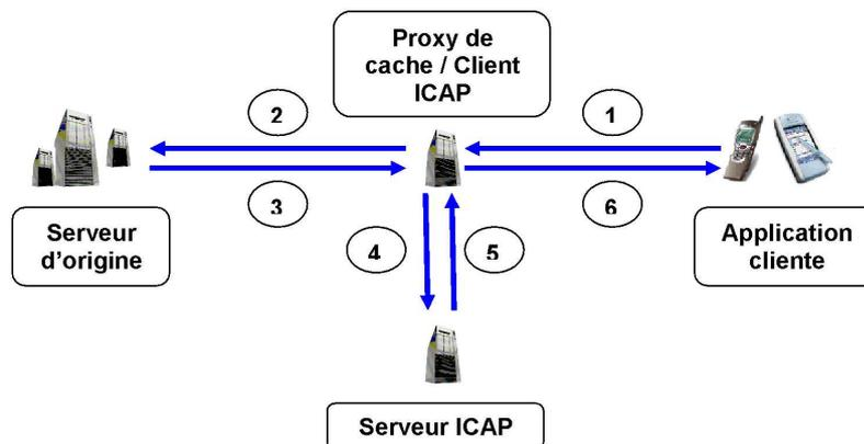
FIG. 2.24 – Architecture ICAP de modification de réponse
