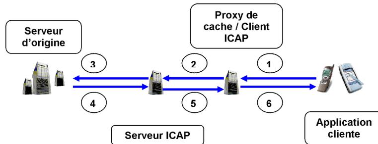
FIG. 2.23 – Architecture ICAP de satisfaction de requête
