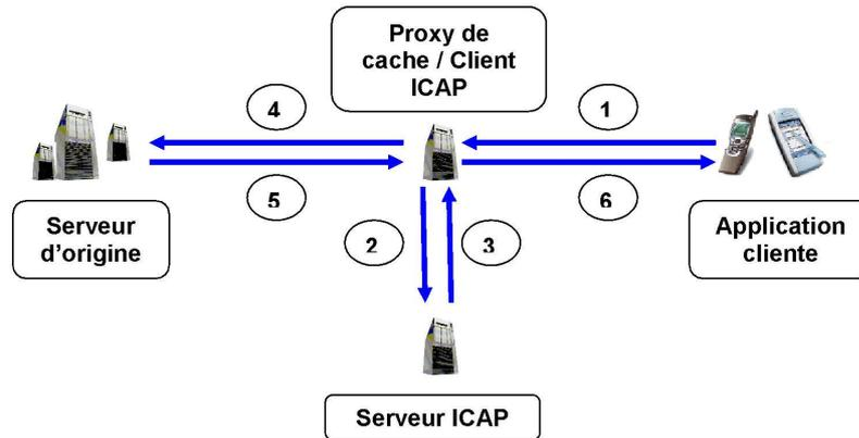
FIG. 2.22 – Architecture ICAP de modification de requête
