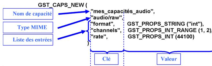
FIG. 2.2 – Déclaration des capacités d'un *Pad*
