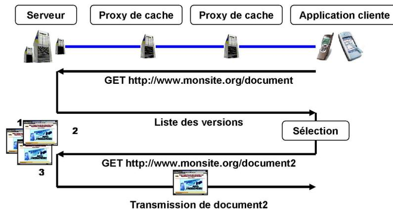
FIG. 2.8 – Modèle de la négociation transparente du contenu
