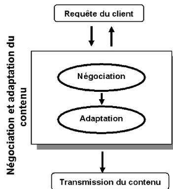
FIG. 5.4 – Vue globale sur le système d'adaptation et de négociation du contenu
