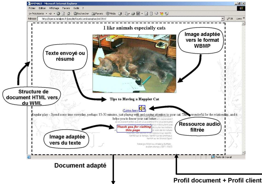
FIG. 3.13 – L'adaptation des ressources d'un contenu
