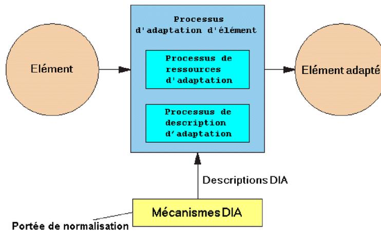
FIG. 2.28 – Architecture d'adaptation de MPEG-21
