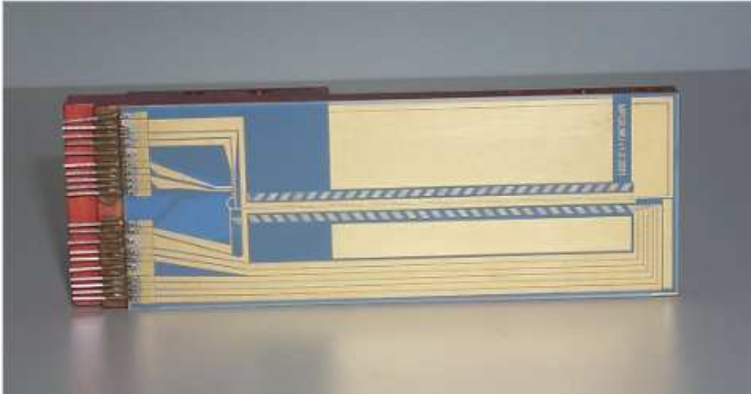
Figure 6.25: Substrat fabriqué avec les connections électriques déjà soudées.
