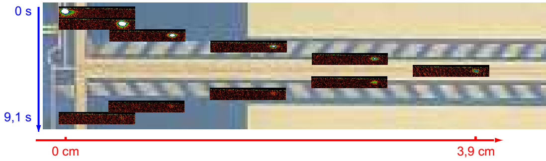
Figure 7.16: Transport optimisé à 3 conducteurs de modulation avec un champ extérieur à une vitesse de 8 mm/s. Images en absorption replacées suivant la distance parcourue par les atomes.
