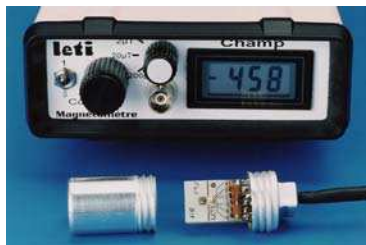
Figure 46 : Capteur magnétique utilisé et son électronique associée
