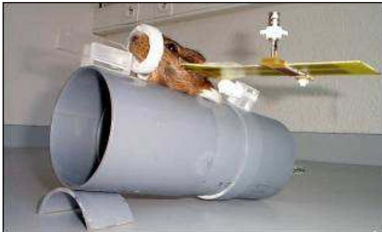
FIG. 1.10 – Système d'exposition "tête-seule" utilisé sur un cobaye
