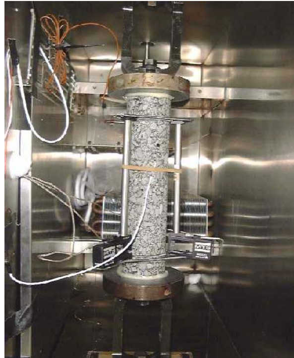
Figure III-13. Montage de l'éprouvette dans l'enceinte MTS.
