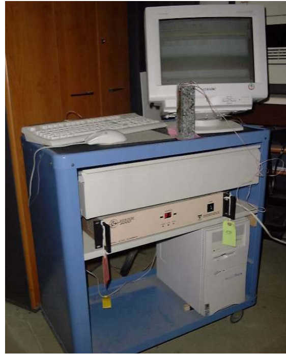
Figure III-10. Dispositif de mesure du coefficient de dilatation/contraction thermique des enrobés.
