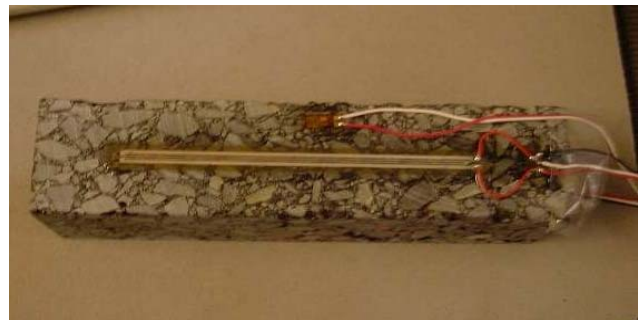
Figure III-8. Eprouvette d'enrobé 4*4*16 \text{ cm}^3 .
