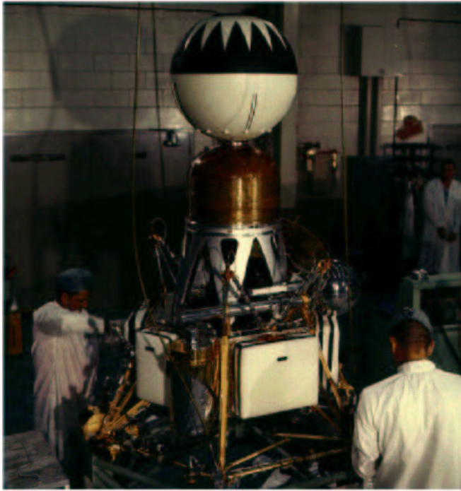
FIG. 1.7 – Sonde Ranger. Le sismomètre était disposé dans la sphère. [photo NASA]
