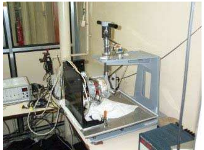
Figure 137 : Essai statique en inflexion
