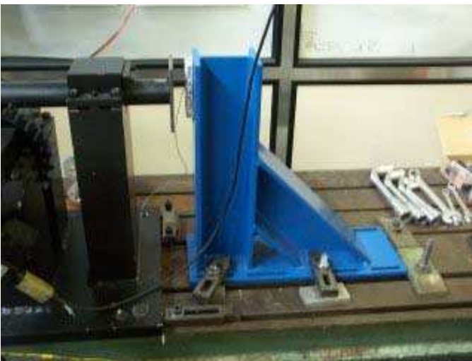
Figure 140 : réglage de la butée
