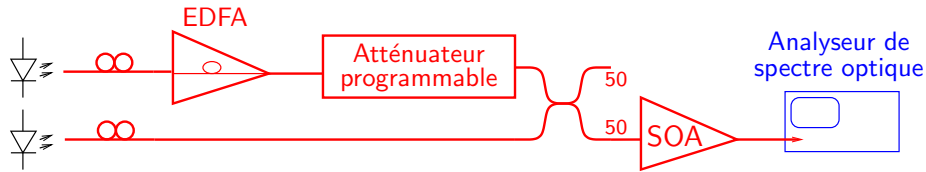
FIG. 4.7 – Observation du mélange à quatre ondes : schéma expérimental.
