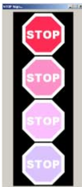
Figure 5-13 : Couleurs rendues pour plusieurs distances (à partir du bas) [1000, 700, 400, 10 m] avec une densité de brouillard de 0.0004\text{m}^{-1} .
