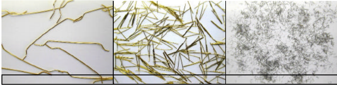
Figure 1.4 - Fibres métalliques utilisées : fibres longues à crochets (à gauche), fibres droites et courtes (au centre) et laine d'acier (à droite) à la même échelle
