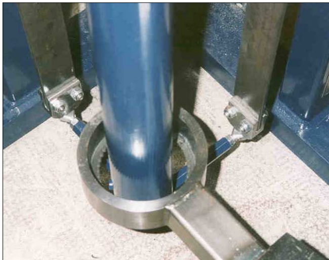
Photo 5 : Système de sécurité sur l'extrémité basse de l'arbre
