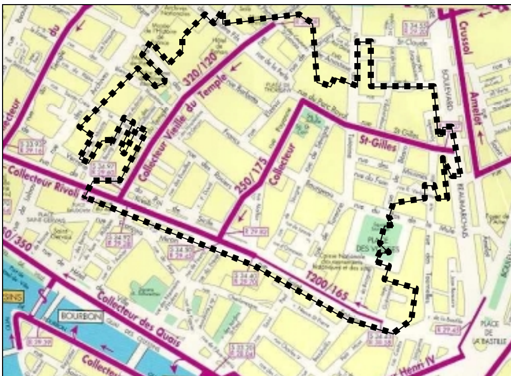
Figure III-11 - Bassin versant du Marais (contours en pointillé)
