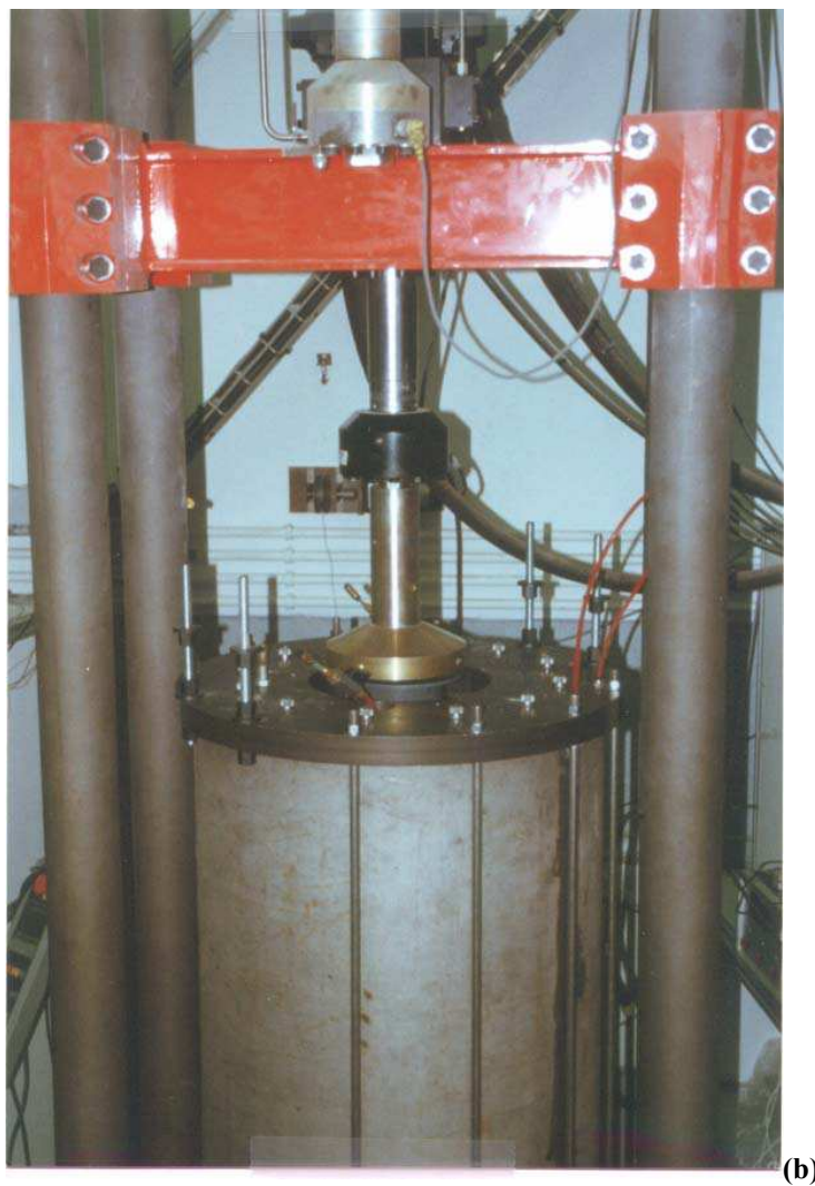
Figure II.26 Vues du dispositif d'essai : (a) positionnement du dispositif de chargement avant essai ; (b) chargement du réseau
