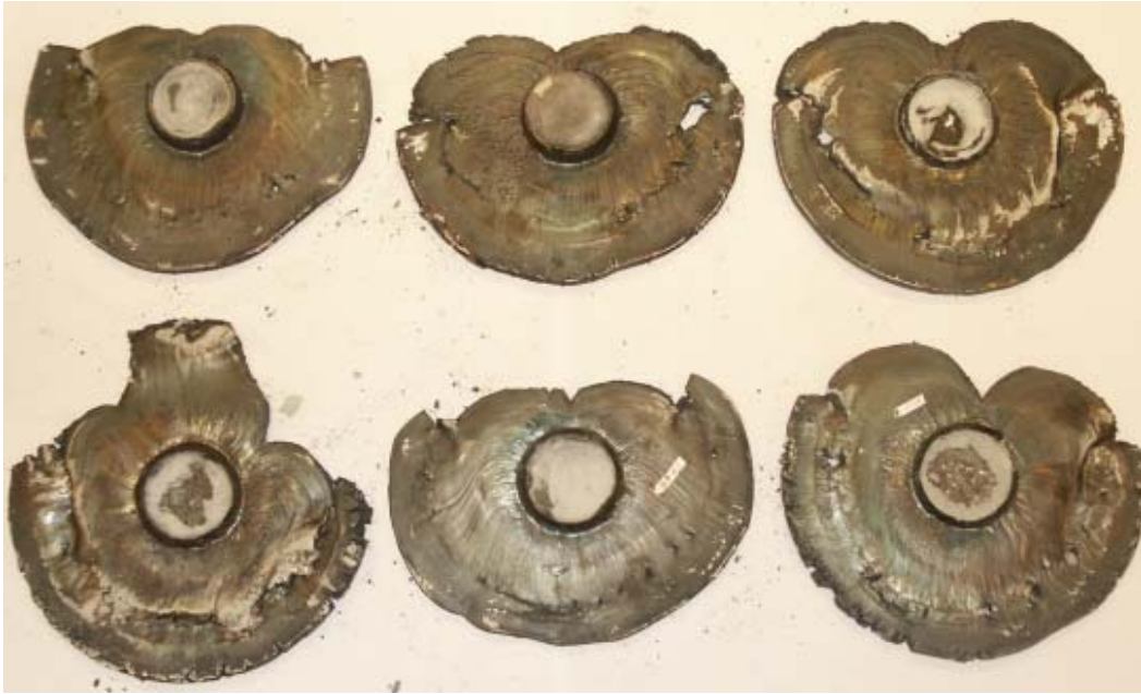
Figure 36: série de pièces obtenues pour une épaisseur filée de 6 mm
