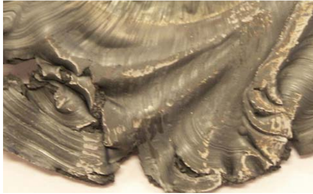
Figure 39 : Zoom sur les replis de matière observés sur les pièces filées sur une pièce d'épaisseur filée de 4mm
