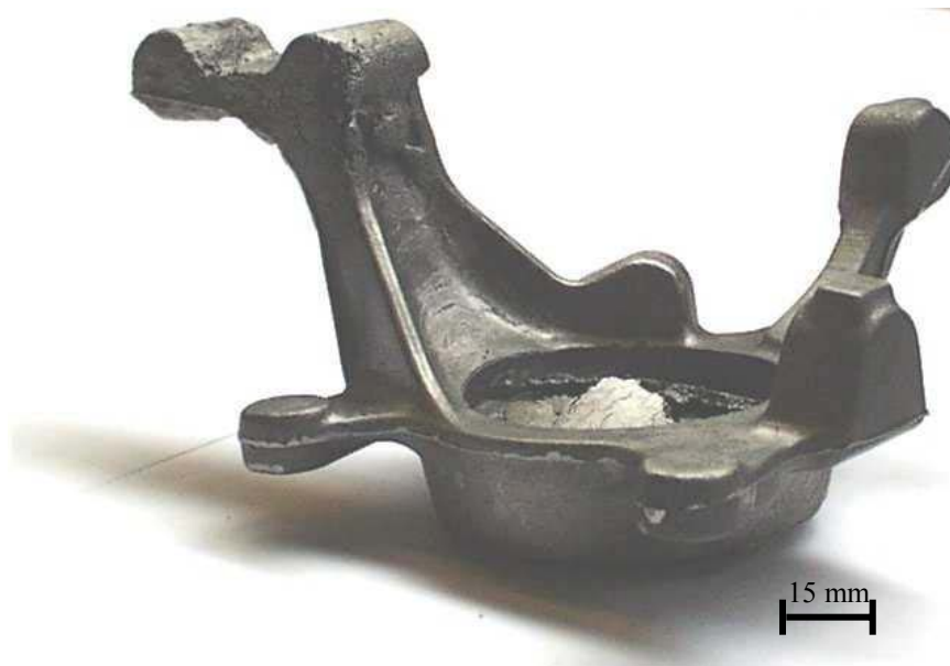
Figure 42 : Porte-fusée thixoforgé en acier c80 réalisé par ASCOMETAL CREAS
