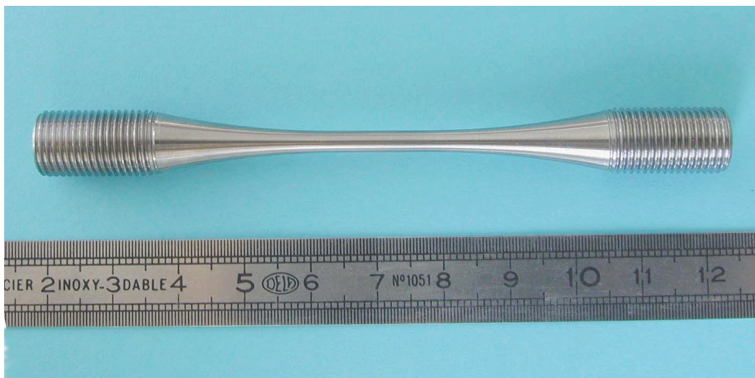
Figure B-2 □ Photo de l'éprouvette cylindrique SCS6/Ti6242
