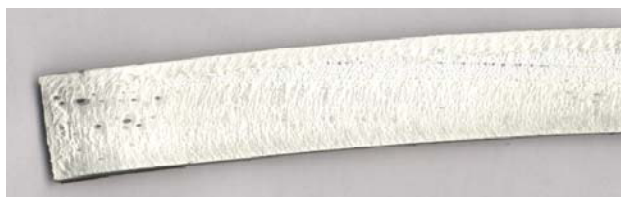
Figure IV.4 :Rupture cohésive dans l'EBA, tube 10 (côté bande)
