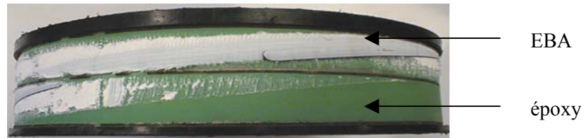
Figure IV.3 : Rupture mixte du tube 9 dans le domaine de transition d'énergie (côté virole)
