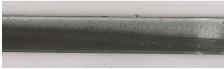
Figure IV.2 : Faciès de rupture adhésive à l'interface EBA/Ep du tube 7 (côté bande)
