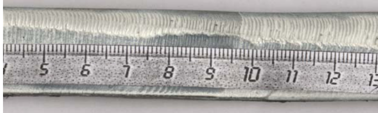
Figure IV.9 : Anomalie de faciès de rupture du tube 10 (côté bande)
