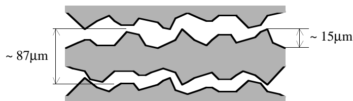
Figure III-24 : Dimensions caractéristiques de l'empilement de plaquettes rugueuses (vue en coupe, perpendiculairement aux plaquettes).
