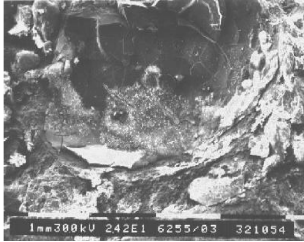
FIG. 2.1 – Produit amorphe de la réaction d'alcali-silice (LCPC, Paris)
