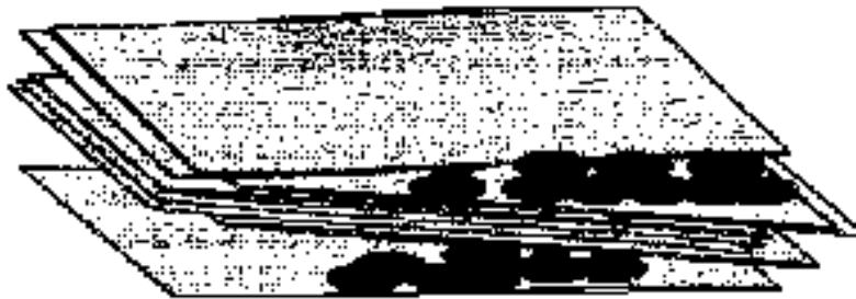
Figure 13 : Calcite dans l'espace intercrystallites des argilites de l'Est. (in Gasc-Barbier et al., 1999)
