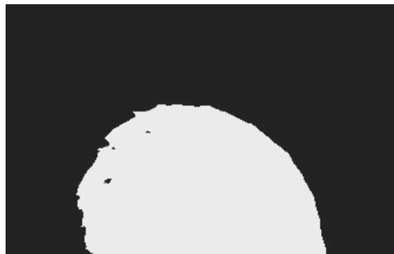
FIG. 4.57 – Aire de contact matériau indenteur pour la rayure avec le cône \theta=30^\circ , \rho=600 \text{ nm} sur le CR39 ® , h=500 \text{ nm} , v=2 \mu\text{m/s} .
