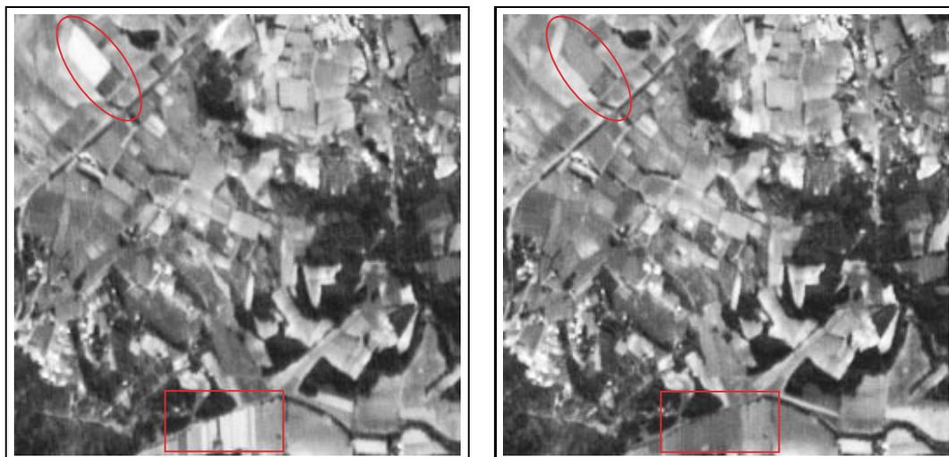
FIG. 3.2 – Extrait du couple stéréoscopique d’Aix-Marseille. Exemples de différence radiométrique importante due au changement de la scène (diachronisme), ici dans le cas de champs.
