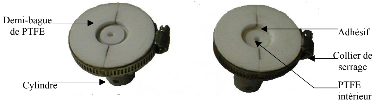
Figure II - 10 : Colle liquide maintenue par la bague de PTFE.
