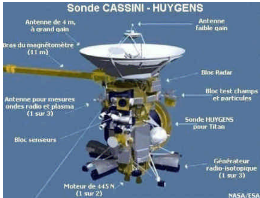
FIG. 1 – Représentation schématique du vaisseau spatial Cassini et de son passager, la sonde Huygens. Les principaux organes de fonctionnement du système sont présentés (crédits NASA/ESA).
