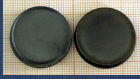
Cibles synthétisées après découpe et polissage diamètre 2,5 cm
