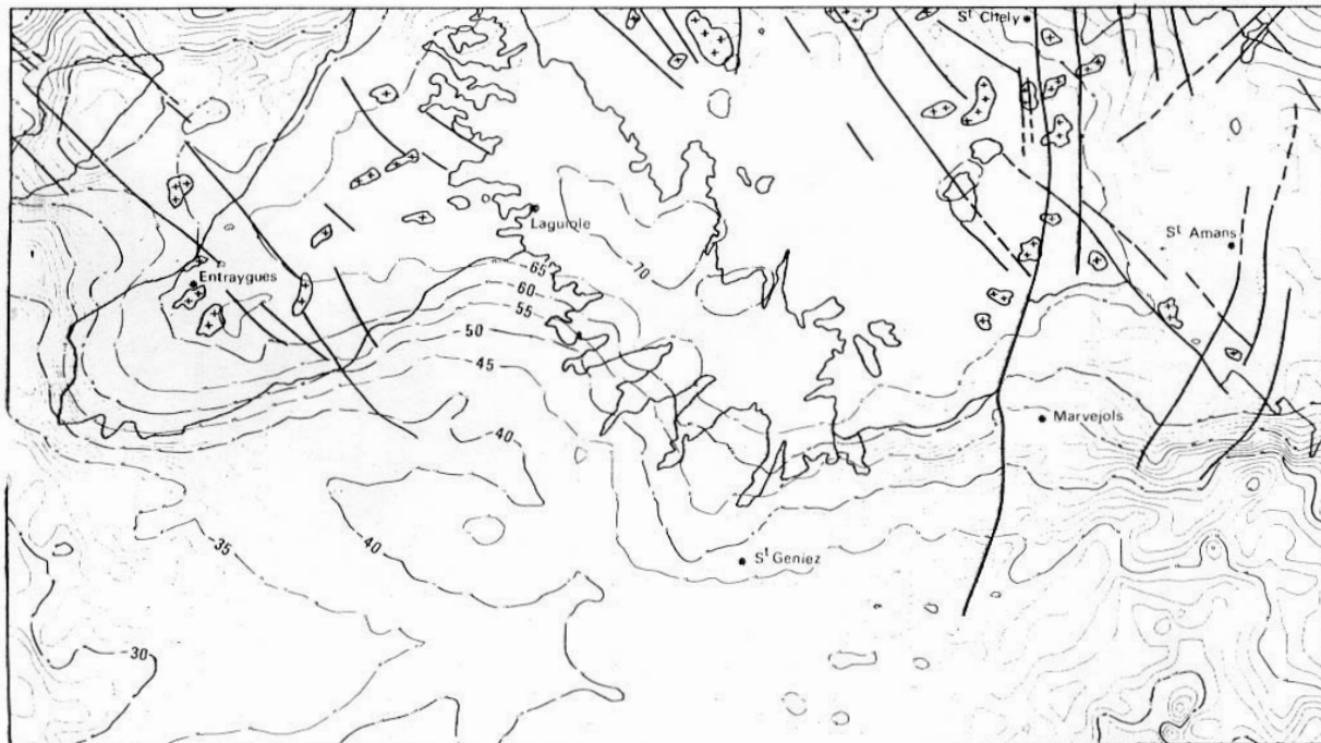
Fig. III-27. Carte des isocontours de l'anomalie de Bouguer complète du granite de la Margeride (Bayer et al., 1982 d'après Pétrequin, 1979).
