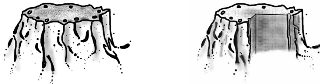
figure 5-28 Modèle proposé du jet Diesel pour P_i \approx 50 \text{ MPa} .
