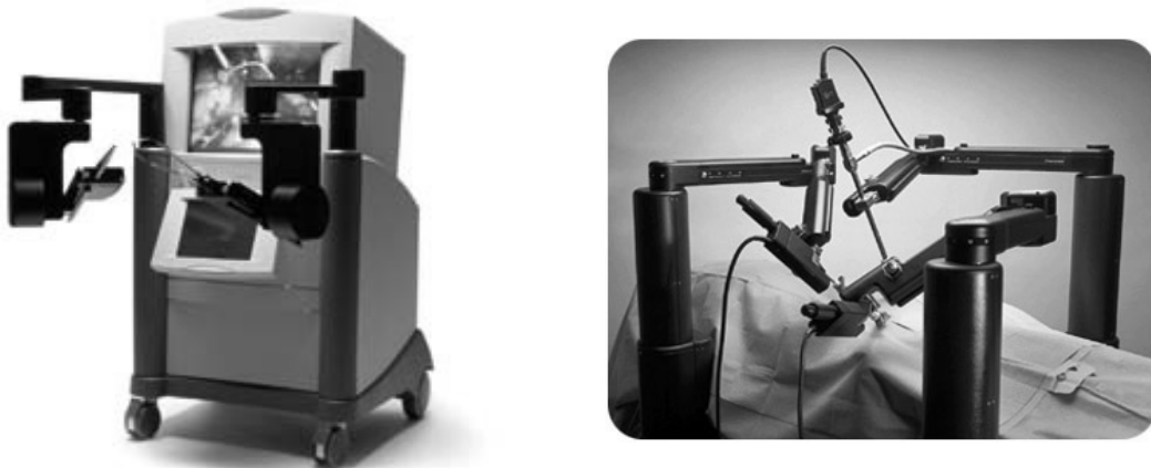
Figure 2.20 - Robot Zeus : console de commande (gauche), console effectrice (droite)
