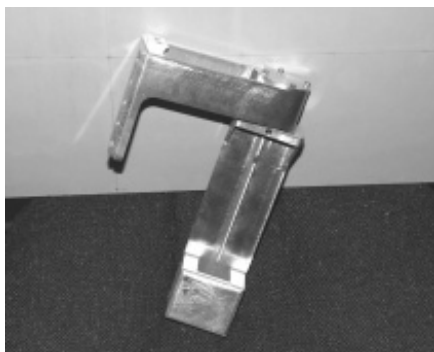
Figure 4.9 - Vues du porte-sonde (à gauche) et du porte-outil (à droite)
