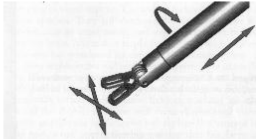
Figure 2.17 - Degrés de liberté d'un outil endoscopique
