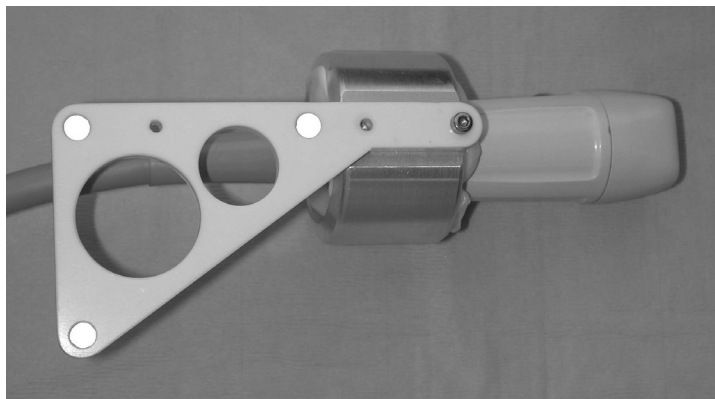
Figure 3.46 - Sonde échographique dédiée à l'application CASPER et équipée d'un SIL
