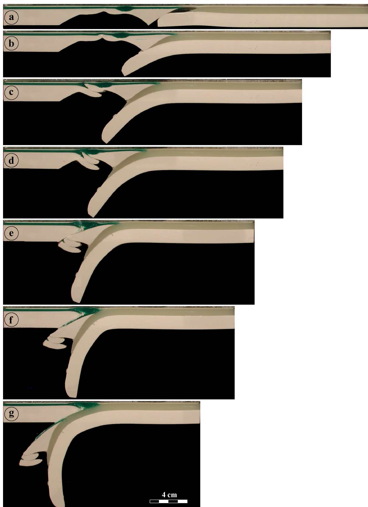
Figure 3.17 – Photos des stades successifs de l'expérience 5 : subduction continentale en régime de forte compression entraînant la rupture de la plaque chevauchante dans le domaine arrière arc et la subduction de la plaque d'arc. Les paramètres du modèle sont indiqués dans le tableau 3.4.
