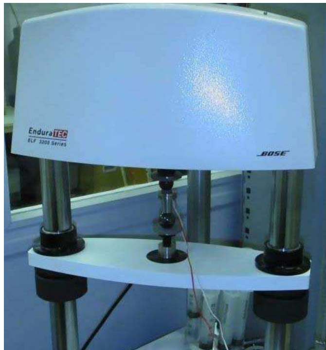
Figure 10.1 – Test de l'Enduratec en compression. Au centre de la photo, on distingue les deux plateaux entre lesquels se trouvent des billes et un capteur d'effort en train d'être calibré.
