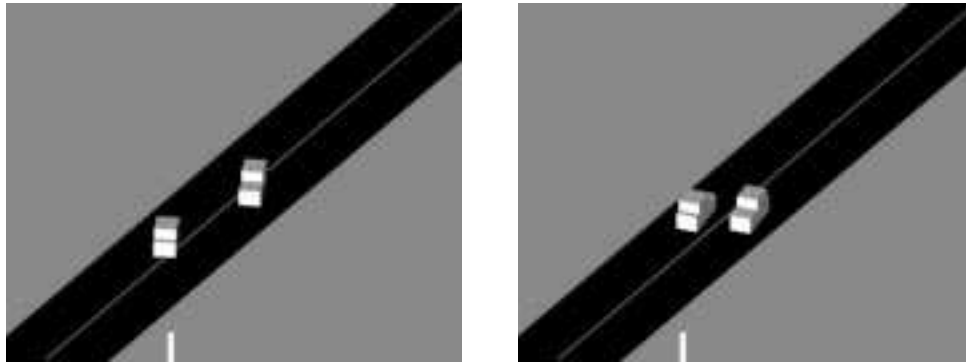
FIG. V.15 –: Exemple d'évitement d'obstacles avec coopération passive dans le cas général : modification locale de la trajectoire nominale
