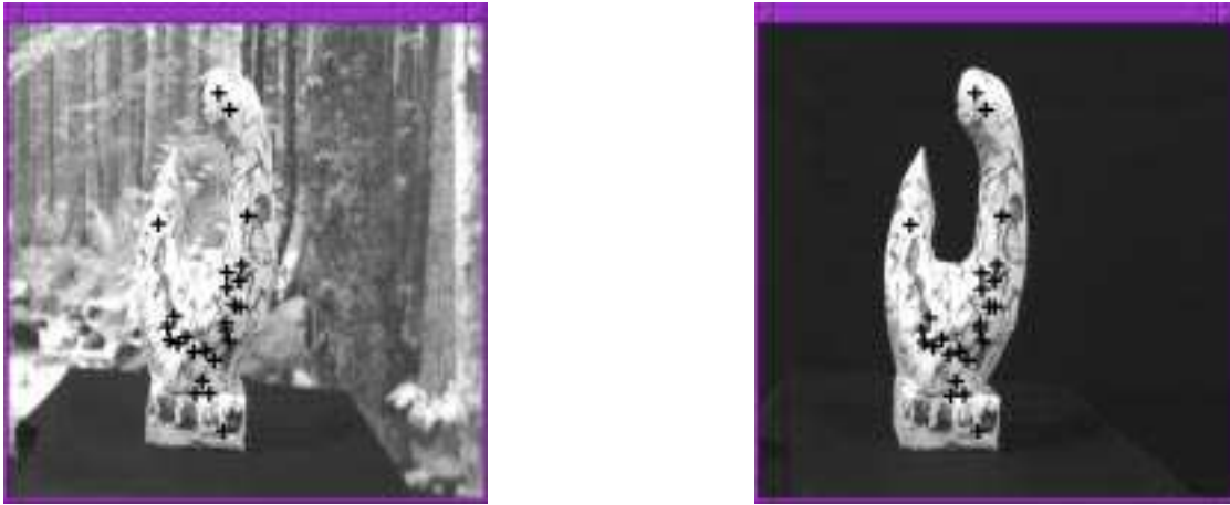
FIG. 6.8 – Illustration des points appariés lors du processus de reconnaissance. L'image de droite a été correctement reconnue à partir de l'image de gauche.
