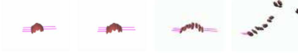
FIG. 4.15 - Éclatement du cylindre
