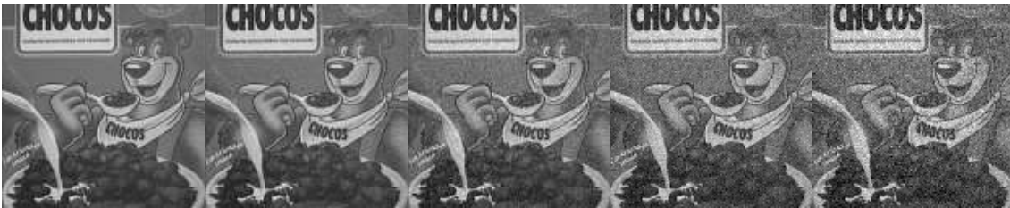
FIG. 5.1 – Stabilité par rapport au bruit additif Gaussien : une de 500 images sans bruit Gaussien (à gauche) et avec du bruit Gaussien de \sigma = 5, 10, 15, 20 (de gauche à droite)
