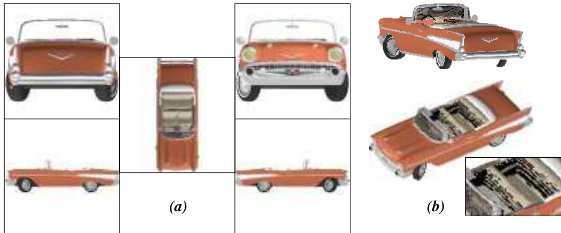
FIG. 3.6 – Un objet multi-texture complexe : (a) les 5 vues pré-calculées, (b) deux images de l'objet multi-texture. On remarque des zones non renseignées sur le dossier des sièges. Le rendu de cet objet est réalisé en moins d'une seconde sur station SUN Ultra Sparc. Le modèle polygonal original est composé de 34000 polygones.
