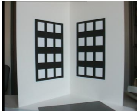
FIG. 3.7: Notre mire de calibrage, construite avec un socle en carton, sur lequel sont fixés deux schémas de grille.
