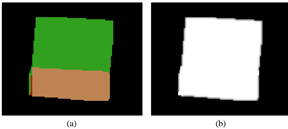
FIG. 5.20: Masques utilisés pour enlever l'ordinateur portable (voir la figure 5.21). (a) Masque représentant les numéros d'identification des polygones masqués par l'objet réel enlevé. (b) Masque indiquant en blanc la région touchée par l'enlèvement de l'objet. La région en noir n'est pas modifiée par le remplissage de texture.
