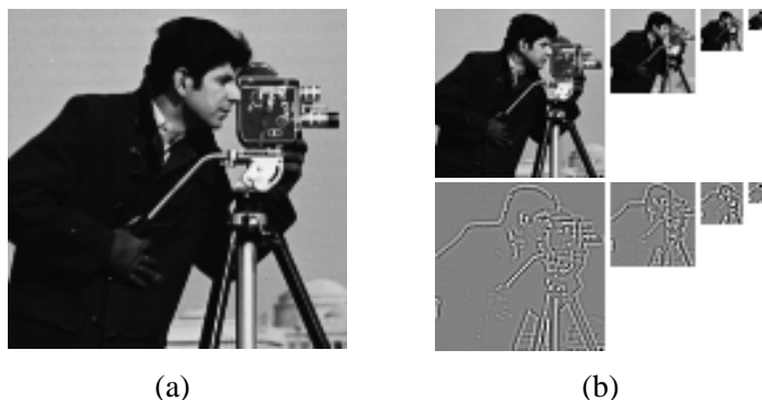
Figure 5.27 – (a) Image de référence. (b) Pyramide passe-bas obtenue à partir de la réduction de l'image de référence et pyramide de différences associée (les niveaux de gris sont amplifiés d'un facteur 2).
