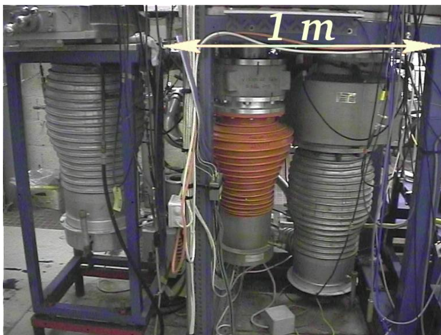
FIG. 4.5 – Les trois pompes principales, de gauche à droite : PS1 (détente), PS2 (canon) et SR (chambre principale)
