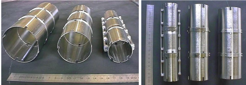
FIG. 5.1 – Le triple blindage magnétique de \mu métal, ici les trois sections non utilisées jusqu'à présent.
