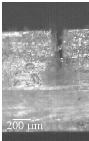
FIG. 3.18 – Sillons réalisés en régime nanoseconde et femtoseconde sur l'échantillon déformé.
