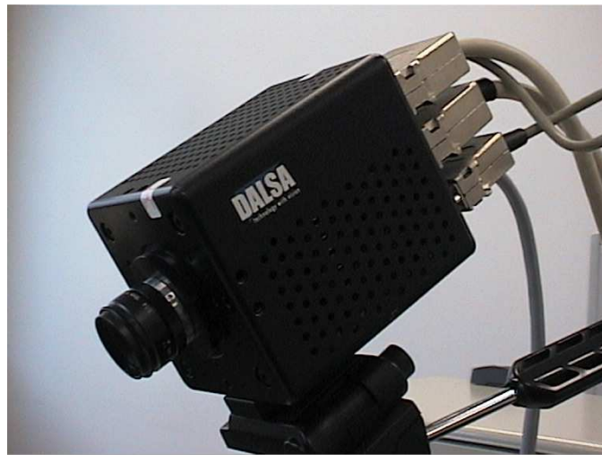
Fig. 2.10: Caméra rapide Dalsa Vision. Cette caméra est capable d'acquérir jusqu'à 955 images de 256 x 256 pixels par seconde. Elle est pilotée en temps réel par un driver sous RT-Linux.
