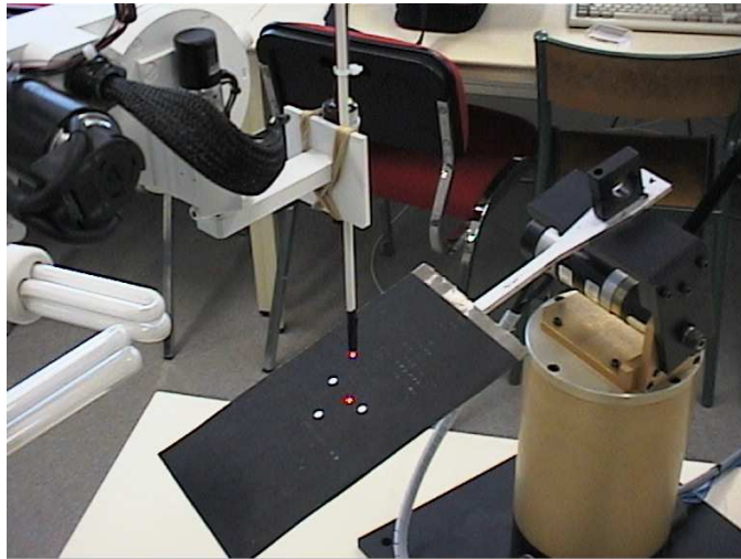
Fig. 6.23: Mini-tournelle orientable utilisée pour la simulation mécanique d'un mouvement de type cardiaque. La tournelle déplace une surface marquée de points blancs.
