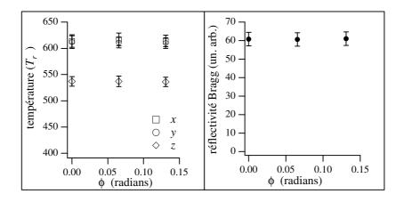
Fig. XII.11: Dépendance résiduelle de la phase  $\phi$  des grandeurs mesurées dans le réseau optique approximant que nous utilisons pour les simulations. (a) température (en unités de  $T_r$ ) en fonction de la phase  $\phi$  pour  $0 < \phi < \pi/24$  (intervalle libre). (b) réflectivité Bragg (en unités arbitraires) toujours en fonction de  $\phi$ . Ces résultats confirment la validité des approximations introduites par le potentiel optique approximant.
