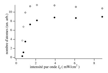
Fig. VII.5: Nombre d'atomes capturés dans un réseau périodique (•) et quasipériodique à six faisceaux (\$) en fonction de l'intensité par onde  $I_0$ . Le nombre d'atomes est evalué (en unités arbitraires) par l'aire d'un signal de temps de vol. Les données sont obtenues pour un désaccord  $\Delta = -125$  MHz. La brusque diminution que l'on peut observer à faible intensité est due au phénomène du décrochage: le réseau n'arrive plus à refroidir et piéger les atomes.
