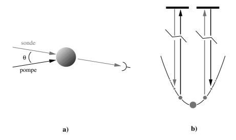
Fig. III.5: Résonances induites par le recul dans un nuage d'atomes libres. (a) Schéma de détection: deux faisceaux forment un petit angle  $\theta$  et on mesure la transmission du faisceau sonde. (b) Transitions Raman entre états d'impulsion différente. Les différences de population (les populations sont schématisées par la dimension des disques gris) conduisent à une amplification de la sonde pour  $\delta < 0$  et à une absorption pour  $\delta > 0$ .
