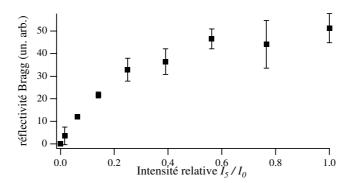
FIG. XII.10: Réflectivité de Bragg (en unités arbitraires) en fonction de l'intensité relative  $I_5/I_0$  obtenue par des simulations 3D. Les conditions de la simulation sont:  $\Delta = -30\Gamma$  et  $\hbar\Delta'_0 = 160E_r$ .
