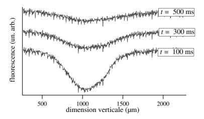
Fig. IX.9: Exemple de profils verticaux d'images utilisés pour l'étude de la diffusion dans le réseau quasi-périodique. Les trois profils sont obtenus à 200ms d'intervalle pour  $I_0 = 5.2 \text{ mW/cm}^2$  et  $\Delta = -50 \text{ MHz}$ . Chaque profil est intégré le long de la direction x.
