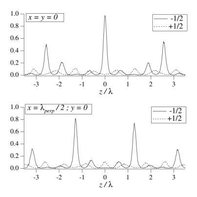
Fig. XII.8: Coupes de la densité atomique dans l'état  $|-1/2\rangle$  (trait continu) et  $|+1/2\rangle$  (pointillé) obtenues le long des deux tubes de potentiel lumineux (lignes de section x = y = 0 et  $x = \lambda_{\perp}; y = 0$ ).
