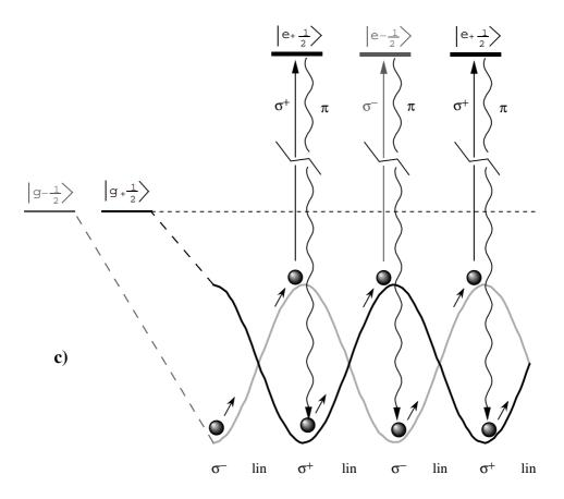
Fig. I.4: La corrélation spatiale entre pompage optique et déplacement lumineux conduit à une perte d'énergie cinétique pour un atome en mouvement : l'atome monte toujours des collines de potentiel mais n'en descend jamais (effet Sisyphe).
