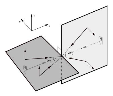
Fig. VII.1: Configuration pour les faisceaux piégeants utilisée pour obtenir un réseau optique incommensurable. Un faisceau supplémentaire (éventuellement rétro-réfléchi) est aligné le long de la bissectrice commune d'une configuration en tétraèdre standard. La polarisation de ce faisceau est circulaire.
