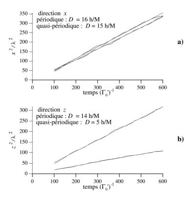
Fig. XI.8: Résultats d'une simulation numérique 2D pour le calcul du coefficient de diffusion. L'évolution des grandeurs  $\langle x^2 - \langle x \rangle^2 \rangle$  et  $\langle z^2 - \langle z \rangle^2 \rangle$  est linéaire en fonction du temps, ce qui montre un comportement diffusif du système. La pente des droites est donc proportionnelle au coefficient de diffusion. On peut remarquer une nette diminution de la mobilité des atomes le long de la direction quasi-périodique (b).
