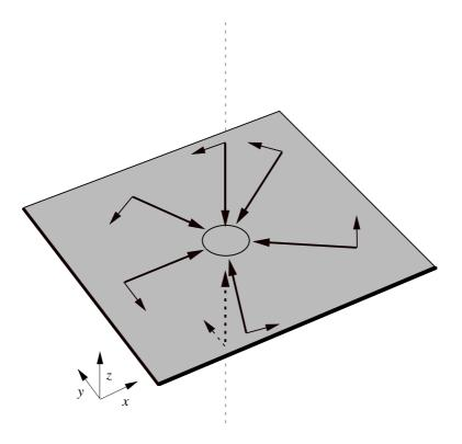
Fig. IX.3: Configuration à sept faisceaux utilisée pour engendrer un potentiel lumineux 3D à symétrie d'ordre cinq. Une onde stationnaire en configuration lin $\perp$ lin le long de l'axe z est ajoutée aux cinq faisceaux disposés selon la symétrie pentagonale. Toutes les polarisations sont parallèles au plan xy, ce qui annule la composante z du champ, comme dans le cas du tétraèdre standard.
