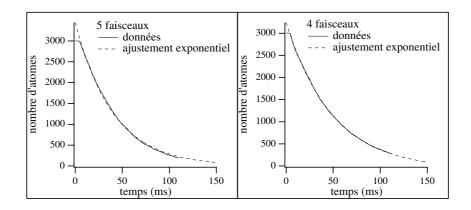
FIG. XII.16: Nombre d'atomes restés dans une sphère de rayon  $500\lambda$  en fonction du temps pour les configurations à cinq faisceaux (à gauche) et à quatre faisceaux (à droite). Les conditions des simulations correspondent à celles de la figure précédente. La durée de vie, estimée par l'ajustement en loi exponentielle (en pointillé), est de 50 ms pour le cas périodique et de 40 ms pour la configuration à cinq faisceaux.
