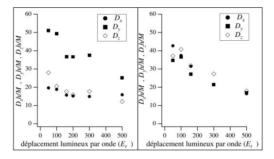
Fig. XII.14: Coefficients de diffusion spatiale (en unités h/M) en fonction du déplacement lumineux par onde  $\hbar\Delta'_0$  obtenus par simulation Monte-Carlo 3D. Le cas du réseau optique quasi-périodique (à gauche) est comparé à celui du tétraèdre standard (à droite).
