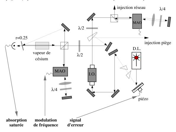
Fig. IV.3: Schéma de montage pour un asservissement par absorption saturée d'une diode laser en cavité étendue. Les faisceaux pompe et sonde sont dérivés du faisceau principal. Le faisceau pompe est ensuite décalé et modulé en fréquence avec le MAO et croise le faisceau sonde dans une cellule contenant de la vapeur de césium. Le reste de la puissance laser est utilisé en partie pour l'injection de la diode piège et en partie pour l'injection du laser qui engendre le réseau.
