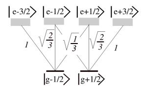
Fig. I.1: Schéma des niveaux et coefficients de Clebsch-Gordan pour une transition de type  $J_g = \frac{1}{2} \rightarrow J_e = \frac{3}{2}$ .
