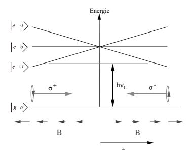
Fig. I.2: Schéma de fonctionnement du piège magnéto-optique (PMO). Un atome sur une transition  $J_g = 0 \rightarrow J_e = 1$  est soumis à un champ magnétique inhomogène  $\mathbf{B} = b\mathbf{z}$  et à un couple de faisceaux laser décalés vers le rouge. La polarisation des deux faisceaux est circulaire opposée. Un atome qui s'éloigne du point z = 0 voit se rapprocher de résonance le faisceau qui se propage dans le sens opposé à son déplacement.
