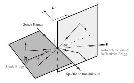
Fig. VII.17: Configuration expérimentale utilisée pour détecter les oscillations atomiques par diffraction de Bragg. Une sonde Raman  $S_R$  qui a un vecteur d'onde orthogonal au cinquième faisceau est utilisée pour mettre en mouvement les atomes dans les puits de potentiel optique.
