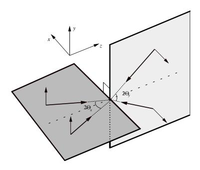
Fig. I.8: Configuration des faisceaux piégeant pour le réseau optique dit en tétraèdre standard. Les deux couples de faisceaux se propagent sur deux plans orthogonaux avec des polarisations linéaires orthogonales aux plans de propagation.
