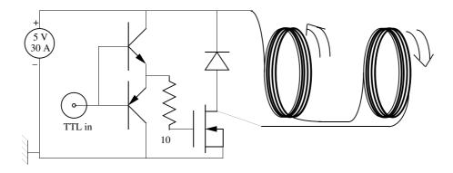
Fig. IV.8: Schéma du montage électronique utilisé pour couper le gradient de champ magnétique du PMO. La diode est une diode de type "transil" (1.5KE8.2CA) qui entre en conduction à 8.2 V. Le FET (BUK556-60H1) supporte un courant de 60 A. Les deux transistors (2N2219 et 2N2905) sont un couple complémentaire. Le temps de coupure mesuré est inférieur à la ms.
