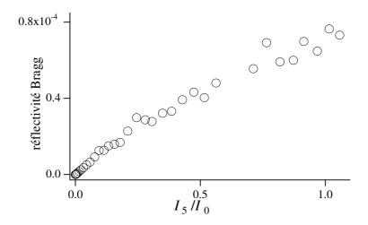
Fig. VII.16: Evolution de la réflectivité de Bragg en fonction de l'intensité du cinquième faisceau pour un réseau optique quasi-périodique. Les données sont obtenues pour  $I_0=7.5~mW/cm^2$ ,  $\Delta=-150~MHz$  (ce qui correspond à une différence de fréquence avec la sonde  $|\Delta-\Delta_B|=145~MHz$ ), puissance de la sonde Bragg  $100 \mu W/cm^2$ .
