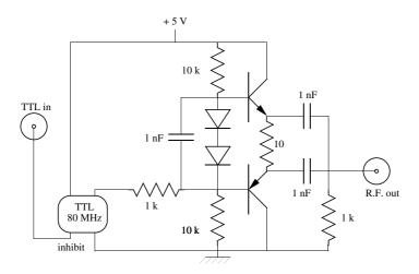
Fig. IV.5: Schéma du montage électronique adopté pour l'alimentation R.F. du MAO qui sert à couper les faisceaux utilisés pour les expériences. Les deux transistors (2N2219 et 2N2905) sont un couple complémentaire. L'entrée "inhibit" du quartz assure une coupure rapide (moins de 10 ns) des oscillations.
