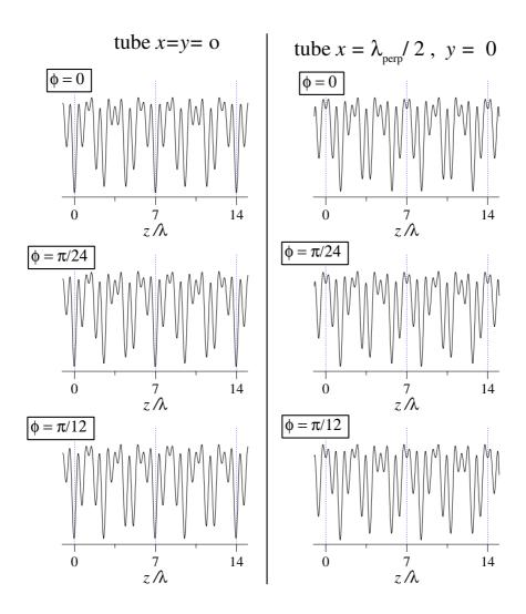
Fig. X.3: Dépendance résiduelle en fonction de la phase pour le potentiel optique approximant utilisé pour les simulations numériques. Des sections du potentiel optique correspondant aux deux familles de tubes sont reportées pour différentes phases  $\phi$ . A la fin de l'intervalle de variation libre  $(0-\pi/12)$ , on retrouve une simple translation qui échange les deux tubes et les déplace de  $5\lambda/4$ .
