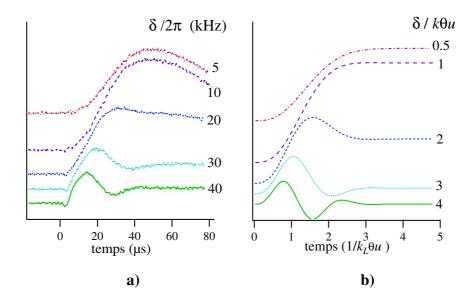
FIG. III.6: Résonances induites par le recul dans le régime transitoire. (a) Transmission de la sonde en fonction du temps pour différentes valeurs de  $\delta$ . L'angle  $\theta$  vaut  $\theta = 10^{\circ}$  et la température T du nuage d'atomes est telle que  $k_L\theta u = k_L\theta (k_BT/M)^{1/2} = 10$  kHz. L'origine des temps est fixée à l'instant d'allumage de la pompe. (b) Signaux de transitoire de recul calculés pour différentes valeurs du paramètre  $\delta/k\theta u$ .
