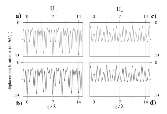
Fig. X.1: Comparaison entre un potentiel optique quasi-périodique et son approximant d'ordre quatre. Dans la colonne de gauche sont réportées les sections le long de la droite x = y = 0 du potentiel optique  $U_-$  (équation X.8b) pour: (a) l'approximant rationnel, (b) le cas quasi-périodique. Dans la colonne de droite est répresenté le potentiel optique pour l'état  $|+1/2\rangle$  (équation X.8a). Pour les coupes du potentiel approximant, la périodicité spatiale est de  $7\lambda_L$ .
