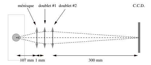
Fig. VIII.3: Schéma du système optique utilisé pour obtenir l'image du nuage d'atomes froids. Le premier couple ménisque-doublet achromatique (Melles Griots 01LAM225+01LAO225) a une longueur focale de 118 mm et est dessiné pour conjuguer l'objet à l'infini. Le deuxième doublet achromatique (Melles Griots 01LAO248) a une longueur focale de 300 mm et est aussi dessiné pour une conjugaison infini-image. L'ouverture numérique globale est de 0.15 et le grandissement g=2.54.
