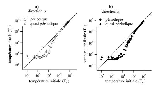
Fig. XI.9: Différences entre la vitesse de capture d'un réseau optique périodique et celle d'un réseau quasi-périodique. Le seuil de température après lequel le réseau n'est plus capable de refroidir tous les atomes est déplacé vers les hautes températures dans le cas du réseau quasi-périodique. Paramètres de simulation:  $\hbar\Delta_0' = 500E_r$ ,  $\Delta = -30\Gamma$ , t = 0.5 ms.
