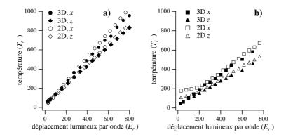
Fig. XII.4: Comparaison globale entre les températures obtenues par simulation 2D et 3D. (a) résultats obtenus pour le cas quasi-périodique à  $\Delta = -30\Gamma$ . (b) résultats obtenus pour le cas périodique à  $\Delta = -30\Gamma$ . Dans le cas périodique 2D le décrochage est visible même si la sélection en position a été appliquée.
