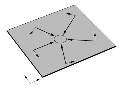
Fig. IX.1: Configuration géométrique utilisée pour engendrer un potentiel optique à 2D qui présente une symétrie par rotation d'ordre cinq. La polarisation des faisceaux piégeants est choisie parallèle au plan de propagation.
