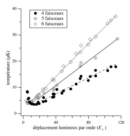
Fig. VII.7: Variation de la température en fonction du déplacement lumineux par onde  $\Delta_0'$  pour un réseau périodique à quatre faisceaux (•), un réseau quasipériodique à cinq faisceaux (⊕) et un réseau quasi-périodique à six faisceaux (⋄). Les données correspondent à plusieurs désaccords compris entre -25 et -160 MHz. Dans la configuration à cinq faisceaux, la pression de radiation impose une limite au désaccord  $\Delta$ : les points correspondent à 100 MHz<  $|\Delta| < 160$  MHz.
