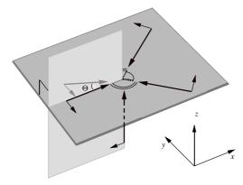
Fig. VIII.1: Configuration à cinq faisceaux utilisée pour obtenir un réseau optique super-périodique. Tous les faisceaux sont polarisés parallèlement au plan xy et l'angle  $\Theta$  entre le vecteur d'onde du cinquième faisceau et le plan xy est très petit (de l'ordre de la dizaine de milliradiants).
