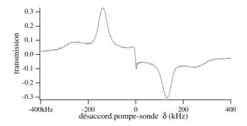
Fig. III.1: Spectre de transmission expérimental obtenu en balayant la fréquence d'une sonde  $\omega_s$  autour de la fréquence des faisceaux piégeant  $\omega_L$  dans un réseau optique en tétraèdre standard. Conditions expérimentales:  $\Theta_x = \Theta_y = 55 \pm 1^\circ$ , Intensité par faisceau  $I_0 = 17 \text{ mW/cm}^2$ , intensité de la sonde  $I_s = 110 \mu \text{ W/cm}^2$ , direction de la sonde  $\mathbf{x} + \mathbf{y}$ , polarisation de la sonde dans le plan xy.
