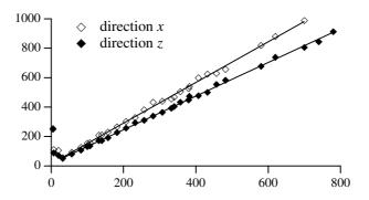
Fig. XI.3: Température cinétique selon les directions x et z pour un réseau optique quasi-périodique (approximant). La température selon z est systématiquement plus faible que celle selon x. le rapport des pentes dans la partie linéaire vaut  $1.21 \pm 0.05$ .
