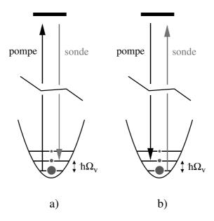
FIG. III.2: Schéma des processus Raman qui engendrent les pics principaux dans un spectre de transmission. (a): lorsque  $\delta = -\Omega_v$ , le processus dominant (à cause de la différence de population) est l'absorption d'un photon pompe suivi de l'émission d'un photon sonde (gain pour la sonde). (b): pour  $\delta = \Omega_v$  c'est la sonde qui est préférentiellement absorbée.
