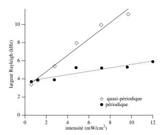
Fig. VII.13: Evolution de la largeur de la composante Rayleigh en fonction de l'intensité  $I_0$  pour un réseau quasi-périodique à six faisceaux ( $\diamond$ ) et pour un réseau périodique ( $\bullet$ ). Conditions expérimentales:  $\Delta = -35$  MHz, intensité de la sonde  $400 \ \mu W/cm^2$ , polarisation de la sonde  $\sigma^+$ . Les données sont obtenues par la technique des transitoires cohérents; la méthode garantit une résolution de 300 Hz, limitée par la stabilité mécanique du montage.
