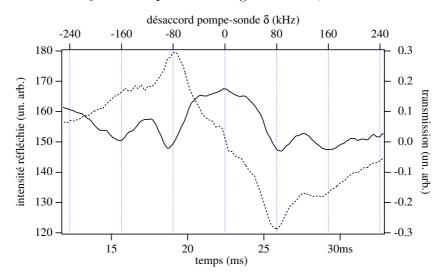
Fig. VII.18: Réflectivité Bragg (trait continu) et transmission d'une sonde transverse  $S_R$  (pointillé) en fonction du désaccord  $\delta$  entre les faisceaux piégeants et la sonde  $S_R$ . Le réseau quasi-périodique à six faisceaux est obtenu pour  $\Delta = -150$  MHz et  $I_0 = 12.2$  mW/cm². Sur l'axe de gauche est reportée l'échelle de réflectivité de Bragg, sur l'axe du haut le désaccord pompe-sonde  $\delta/2\pi$  et sur l'axe du bas, le temps.
