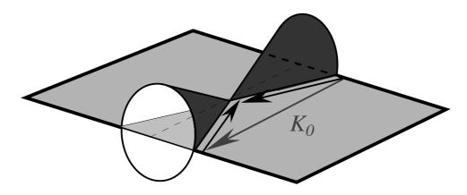
Fig. III.9: Diffraction de Bragg dans les réseaux optiques. La condition de Bragg définit un cône qui a comme axe un vecteur du réseau réciproque  $\mathbf{K}_0$ . En particulier, chaque couple de faisceaux piégeant appartient à un cône.
