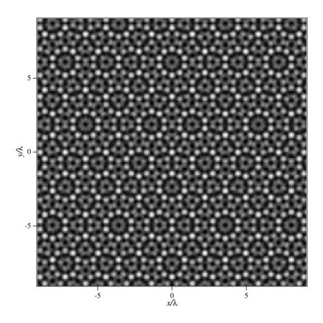
Fig. IX.2: Potentiel lumineux de type "Penrose" obtenu à l'aide de la configuration montrée dans la figure précédente pour une transition atomique  $4 \rightarrow 5$ . Les atomes ont tendance à s'accumuler dans les minima du potentiel (en clair dans la figure). Comme on peut le constater, ce potentiel n'est pas invariant par translation bien qu'il conserve une très grande régularité.
