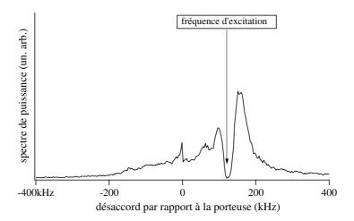
Fig. VII.14: Spectre de puissance d'un signal de transitoire cohérent obtenu pour un réseau optique quasi-périodique à six faisceaux. Les conditions expérimentales sont:  $\Delta = -150$  MHz,  $I_0 = 17$  mW/cm², intensité sonde  $400\mu$ W/cm², polarisation de la sonde  $\sigma^+$ . La fréquence excitatrice de la sonde est indiquée par une flèche. On observe un net effet de saturation.
