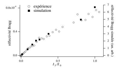
Fig. XI.7: Comparaison entre réflectivité de Bragg mesurée (échelle de gauche) et réflectivité de Bragg simulée (échelle de droite, en unités arbitraires). Même si la valeur absolue de la réflectivité mesurée est cinq fois plus faible de celle calculée, il y a un bon accord pour les variations relatives.
