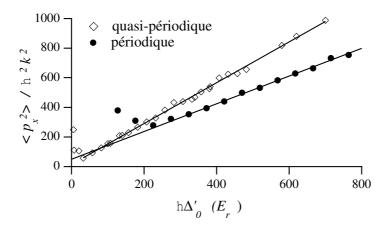
Fig. XI.1: Comparaison entre les températures cinétiques selon la direction x obtenues pour la configuration à cinq faisceaux ( $\diamond$ ) et à quatre faisceaux ( $\bullet$ ). Le rapport entre les pentes de la partie linéaire  $(1.50\pm0.05)$  est en très bonne accord avec la valeur expérimentale  $(1.55\pm0.12)$ . Pour les faibles profondeurs des puits du potentiel optique, le déséquilibre de la pression de radiation fausse les résultats dans le cas périodique.
