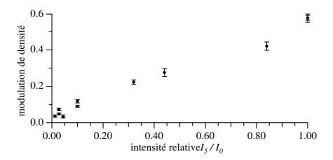
Fig. VIII.6: Variation de la modulation de densité atomique en fonction de l'intensité du cinquième faisceau  $I_5$  dans un super-réseau optique. La modulation de densité est mesurée sur des images obtenue par effet d'ombre.
