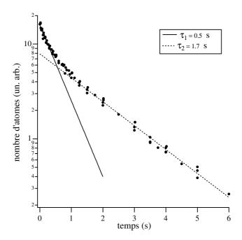
Fig. IX.7: Nombre d'atomes en fonction du temps de piégeage pour un quasicristal optique à sept faisceaux. On peut distinguer deux échelles de temps. La perte d'atomes aux temps courts est probablement due à des effets de densité.
