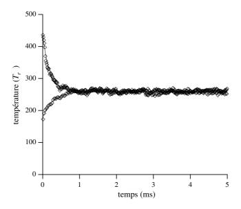
Fig. XII.1: Température dans la direction x en fonction du temps pour un réseau optique quasi-périodique. Deux situations sont reportées dans la figure : la température initiale est choisie plus élevée ou moins élevée que la température d'équilibre. Les constantes de temps, obtenues par un ajustement en loi exponentielle, valent respectivement  $260 \pm 15$  ms (chauffage) et  $178 \pm 5$  ms (refroidissement). La simulation est obtenue pour  $\Delta = -30\Gamma$  et  $\hbar\Delta_0' = 200E_r$ .
