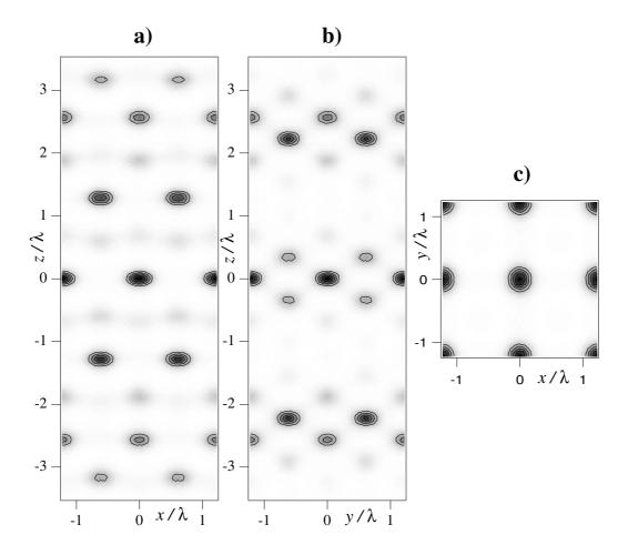
FIG. XII.7: Densité atomique dans l'état  $|-1/2\rangle$  obtenue par simulation 3D dans le cas d'un réseau optique quasi-périodique. (a) coupe selon le plan xz; (b) coupe selon le plan yz; (c) coupe selon le plan xy. Les atomes sont mieux localisés que dans le cas 2D présenté dans le chapitre précédent. Les conditions de la simulation sont:  $\hbar\Delta_0' = 160E_r$  et  $\Delta = -30\Gamma$ .
