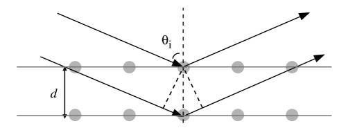
Fig. III.8: Diffraction de Bragg dans un cristal. La condition d'interférence constructive entre les réflexions dues à deux plans successifs impose, pour une sonde de longueur d'onde  $\lambda_b$ , un angle d'incidence tel que  $2d\cos\theta_i = n\lambda_b$ .
