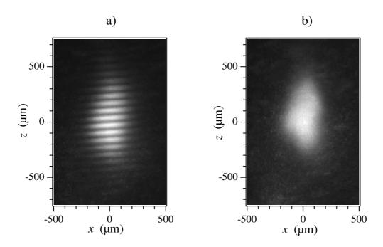
Fig. VIII.4: Images de la fluorescence émise par un réseau optique. (a) réseau super-périodique obtenu avec la configuration à cinq faisceaux reportée en figure VIII.1. (b) réseau périodique obtenu en l'absence du cinquième faisceau. Dans les deux cas, l'intensité par onde est  $I_0 = 4 \text{ mW/cm}^2$  et le désaccord  $\Delta = -100 \text{ MHz}$ .
