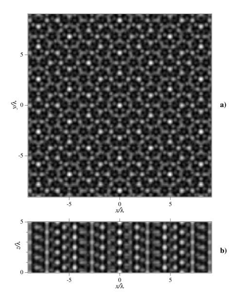
Fig. IX.4: Sections dans le plan xy (a) et dans le plan xz (b) du potentiel lumineux pour un atome sur une transition  $4 \to 5$  obtenu avec une configuration à sept faisceaux. Les minima du potentiel sont représentés en clair. Le potentiel peut être vu comme un empilement périodique le long de la direction z de plans quasi-périodiques. La période spatiale le long de l'axe z est de  $\lambda_L$ .
