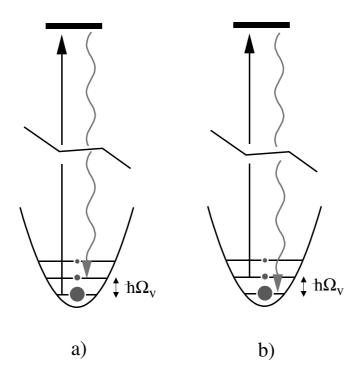
Fig. III.7: Processus Raman spontané dans un réseau optique. (a) Transition Raman Stokes spontanée: l'atome absorbe un photon dans un faisceau piégeant et émet un photon spontané qui le fait tomber dans une bande plus énergétique. (b) Transition Raman anti-Stokes: le photon émis est à une fréquence plus haute que celle des faisceaux piégeant.
