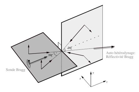
Fig. VII.15: Schéma de détection utilisé pour la mesure de la diffraction de Bragg dans un réseau optique quasi-périodique à cinq faisceaux. La sonde de Bragg  $S_B$  est alignée sur le cinquième faisceau avec une précision du mrad. L'onde diffractée dans la direction d'un autre faisceau est détectée par une méthode d'hétérodynage: une photodiode rapide (bande passante  $\simeq 1$  GHz) mesure le signal de battement et l'envoie à l'analyseur de spectre.
