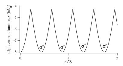
Fig. I.9: Section d'un potentiel lumineux adiabatique 3D pour la transition  $4 \rightarrow 5$  (nappe la plus déplacée) obtenu avec la configuration en tétraèdre standard. La section correspond à la droite x=y=0 dans une situation où les faisceaux sont alignés sur les axes d'un tétraèdre régulier. Mis à part la différence des échelles verticales et horizontales, cette section est identique au potentiel 1D de la figure I.6.
