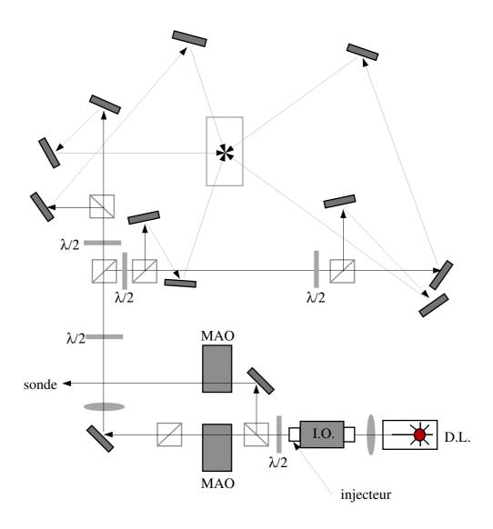
Fig. IV.6: Schéma d'acheminement des faisceaux pour engendrer un réseau optique quasi-périodique à symétrie cinq. La séparation entre les différents bras du réseau est obtenue à l'aide de lames demi-onde et de cubes polariseurs. Le faisceau sonde, utilisé dans les expériences de spectroscopie non-linéaire, est aussi obtenu de la même façon. Dans ce cas, la séparation est faite avant de passer par le MAO à fréquence fixe qui assure l'extinction des faisceaux.
