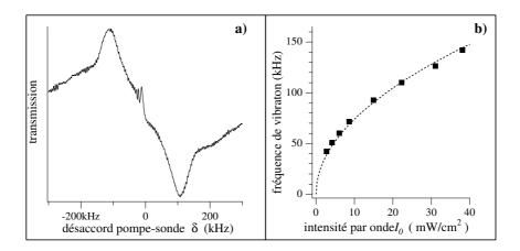
Fig. IX.8: Spectroscopie pompe-sonde d'un quasicristal optique à sept faisceaux. (a) Exemple de spectre de transmission obtenu pour  $I_0=22~mW/cm^2$  et  $\Delta=-125~MHz$ . La sonde se propage dans le plan xy, sa polarisation est parallèle au plan et sa puissance est de  $700 \mu W/cm^2$ . (b) Variation de la fréquence de vibration en fonction de l'intensité par onde  $I_0$  obtenue pour  $\Delta=-125~MHz$ . Le trait pointillé est un ajustement avec la loi  $\Omega_v \propto I_0^{0.5}$ .
