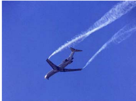
FIG. 4.3 – Tourbillons contrarotatifs derri re un Boeing 727 (photo NASA)
