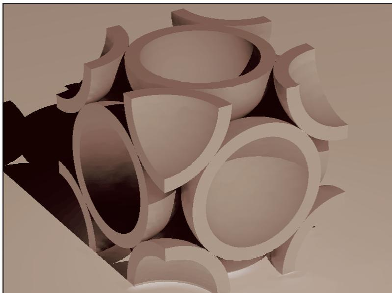
**Figure 4.4 : Image de synthèse de la cellule conventionnelle cubique ; les cols de soudure ne sont pas figurés**
