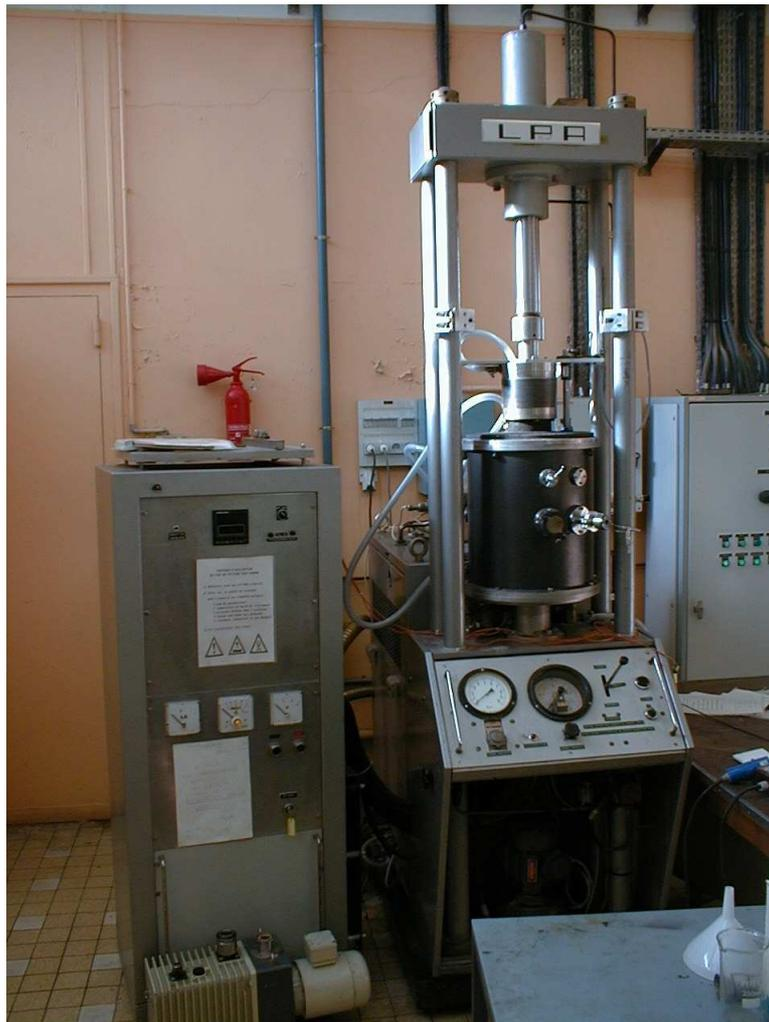
**Figure 1.6 : Four Goliath utilisé pour le brasage des empilements de billes**
