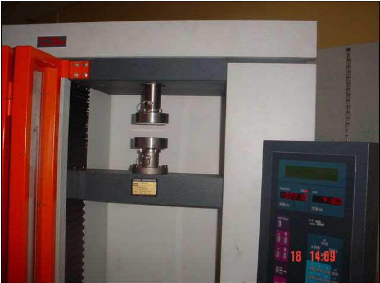
Figure 1.15 : Machine de compression pour les essais mécaniques
