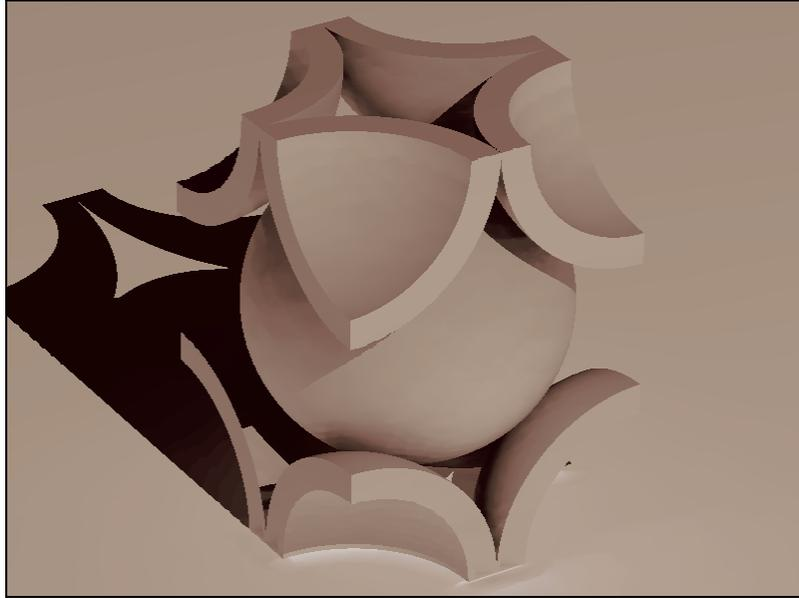
Figure 4.5 : Cellule élémentaire tétragonale de l'empilement CFC
