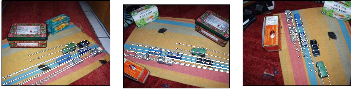
FIG. B.6 – Les points dynamiques sont transférés entre les images en utilisant les homographies induites par le plan de mouvement, c'est à dire comme si ils étaient statiques. Ces homographies sont calculées par la méthode de génération de correspondances statiques (voir texte) et la minimisation non-linéaire de la distance Euclidienne symétrique entre des points transférés et mesurés. L'erreur finale est 0,35 pixels. La solution initiale donnée par la solution analytique pour l'homographie (non montrée ici) est 2,77 pixels.
