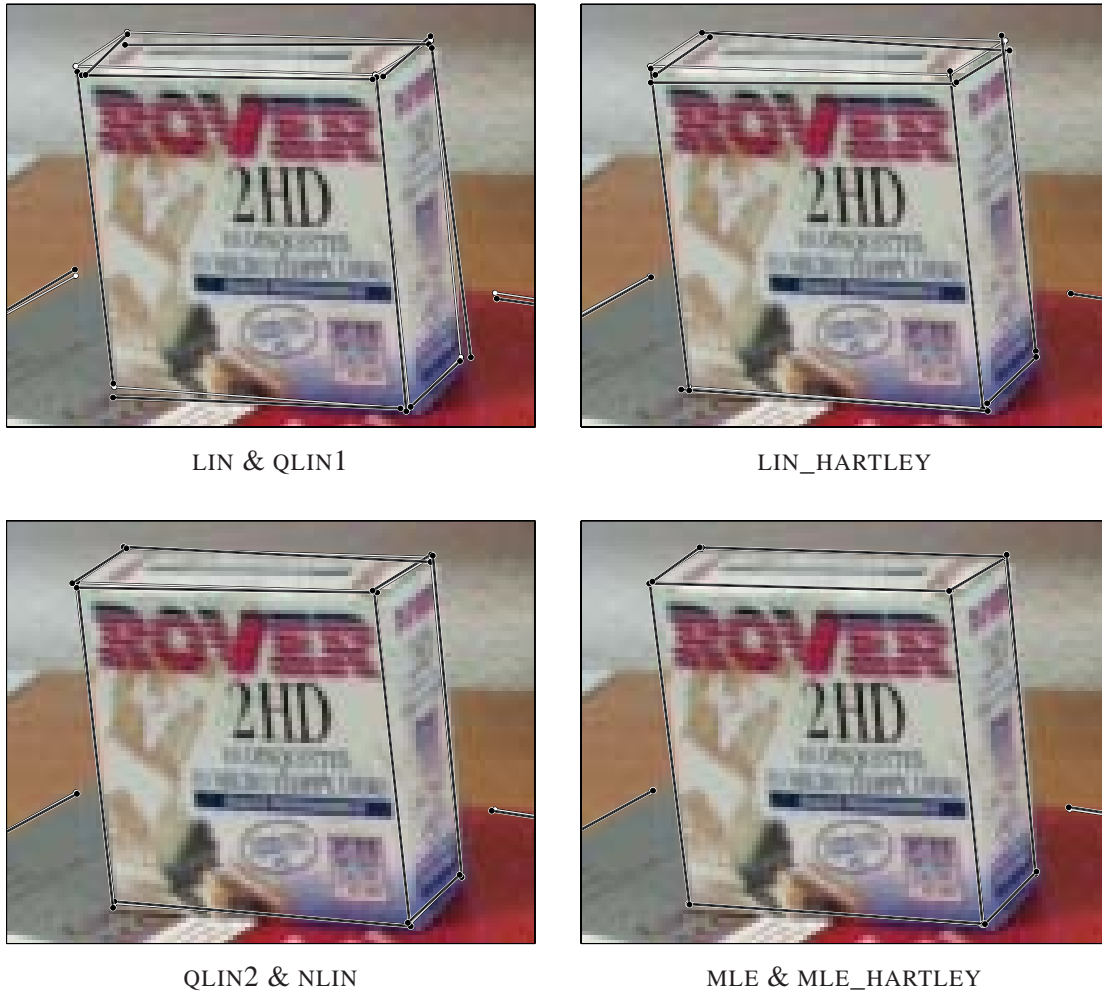
FIG. 6.8 – Zoom sur la reprojection des droites dans les images originales pour différentes méthodes, pour la séquence des livres I. Les droites originales sont en blanc et les droites reprojctées sont en noir.
