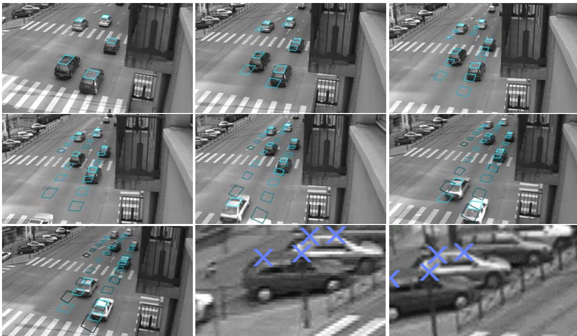
FIG. B.7 – Les homographies inter-images induites par le plan de mouvement sont retrouvées à partir de correspondances de points dynamiques seulement. Elle permettent de transférer la position des véhicules en mouvement d'une image à une autre, comme si ces derniers étaient statiques. Les deux dernières images sont des zooms sur les images 0 et 10 respectivement. La première montre des points statiques sur le plan de mouvement (sélectionnés manuellement), et la deuxième montre le transfert de ces points à l'aide de l'homographie induite par le plan de mouvement, calculée à l'aide de points dynamiques seulement.
