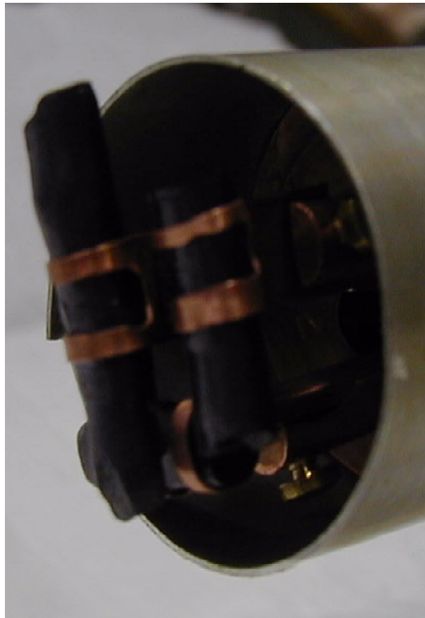
FIG. 2.2: Montage des trois échantillons de \text{Sr}_2\text{RuO}_4 alignés et thermalisés par du cuivre.
