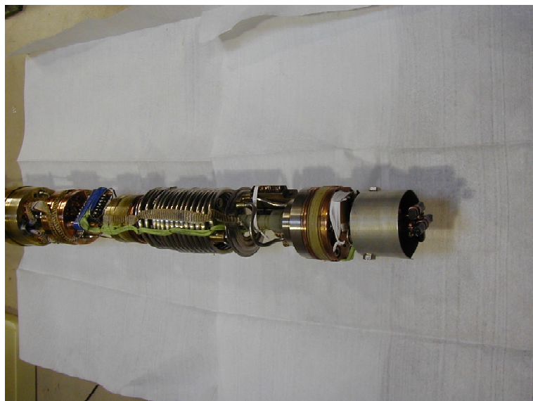
FIG. 2.3: Échantillons montés sur la canne à dilution ^3\text{He} - ^4\text{He} ( T_{\min}=70 mK).
