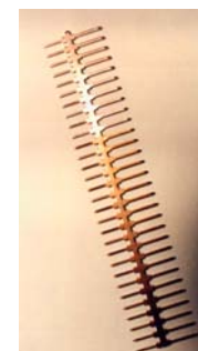
Figure 1.1d: Peigne pour des connexions bas-niveau recouvert d'un film de PAN, traité thermiquement (graphitisation) pour le rendre conducteur.
