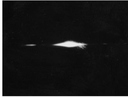
FIG. 4.12: Photographie du mode fondamental en sortie de guide pour l'hétérostructure de type  $Al_{0.03}Ga_{0.97}As/GaAs/Al_{0.03}Ga_{0.97}As$  avec  $\lambda_0 = 1.3 \mu m$ .
