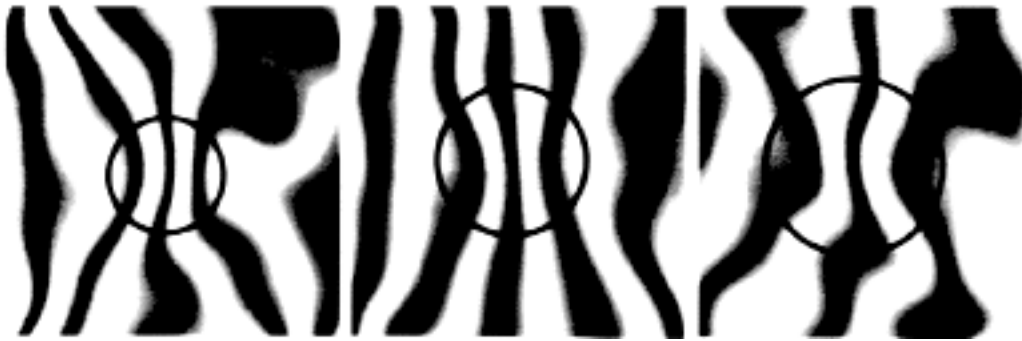
FIG. 1.14 – Images d'interférences d'un vortex dans une couche de Nb à des températures différentes pour un champ magnétique de 100 G. Le cercle noir symbolise les limites du vortex. De gauche à droite: T = 4.5 K, T = 7 K, T = 8 K [4].
