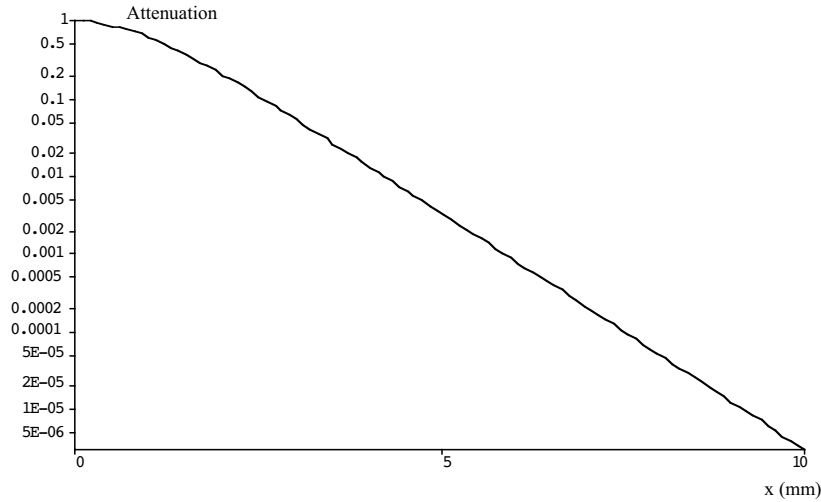
FIG. 1.6 – Le profil de température du filtre HoY pour la pulsation de 0,1 \text{ s}^{-1} à une température de 0,1 \text{ K} et un T_1 de 10 seconde. : plus le filtre va être long, plus l’atténuation sera importante. L’atténuation en fonction de la longueur du filtre est exponentielle.
