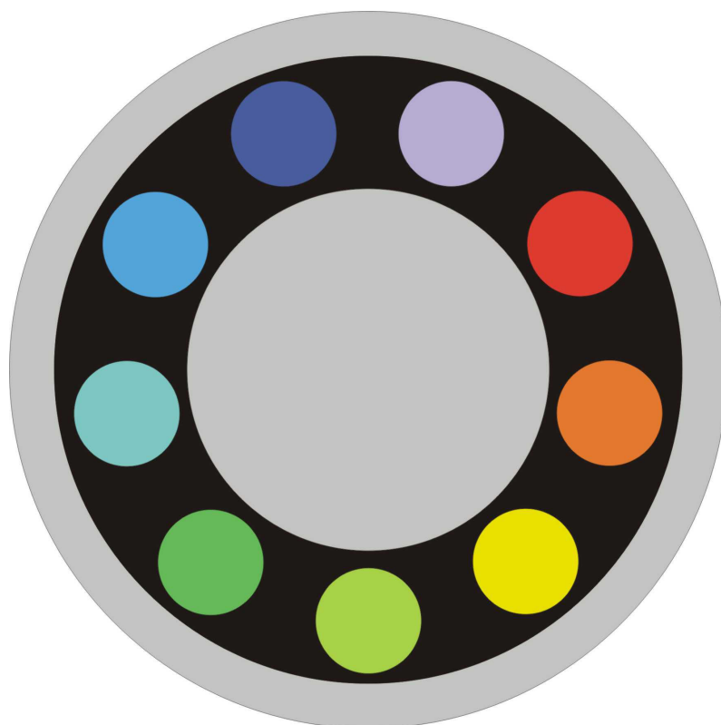
Figure 119. Schéma représentatif de la roue porte filtre équipant le ac-9. Chaque filtre est séparé du suivant par une portion noire qui permet de réaliser la mesure « au noir ».
