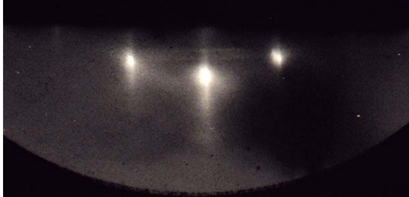
Figure III.5.1.b : diagramme RHEED d'une couche de 3 nm de CaF 2 déposée à 650°C
