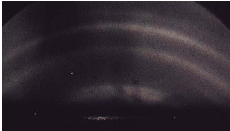
Figure III.5.1.d : diagramme RHEED d'un multipuits de Si/CaF 2 déposée à 25°C
